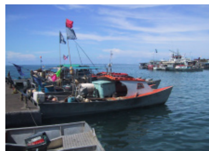
サモアのアピア漁港に停泊する小型マグロ延縄双胴漁船。サモア特有の船で「Alia」と称される。
