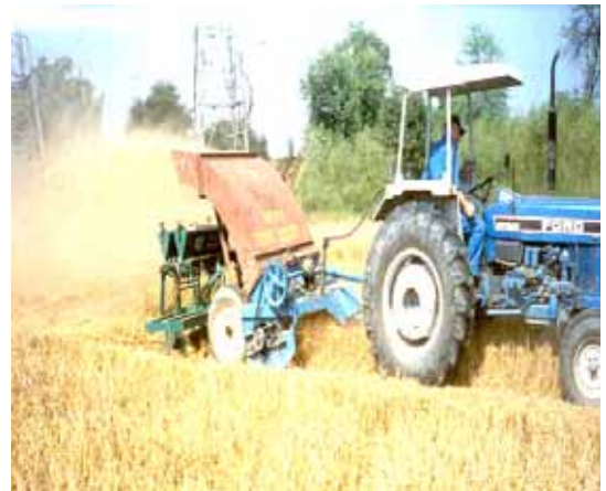
写真1 Happy Seeder - オーストラリア CSIRO・パンジャブ農科大学共同開発による稲のコンバイン収穫畑における小麦の不耕起栽培向け播種機
