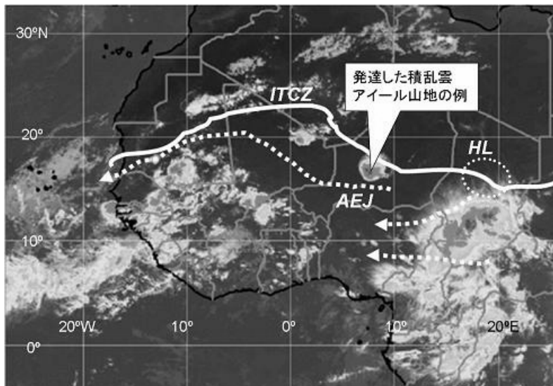
図4 西-中部アフリカ 2007年雨季の活発な対流活動による大雨域分布の一例 07/9/7 18:00 世界標準時 Meteosat-9 IR 画像(ACMAD: AMMA Weather Bulletin, 8 SEPT 2007) ITCZ: 熱帯内収束帯, AEJ: アフリカ東風ジェット, HL: 熱低気圧 (1005hPa)
