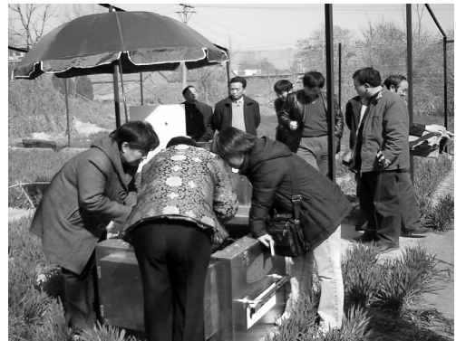
写真2 中国で試作開発した小麦凍霜害解析装置 (温度センサーを設置中)
