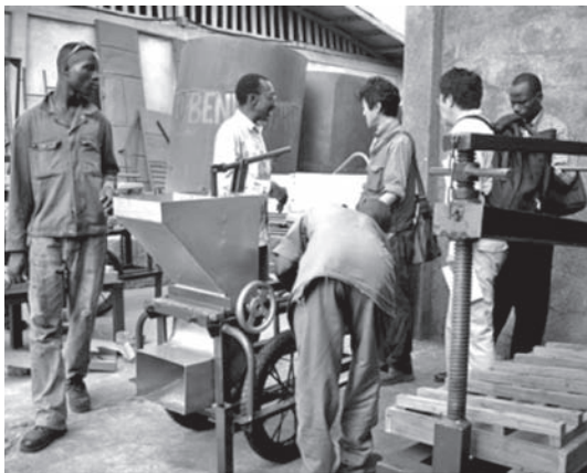
写真3 リヤカーに乗せたキャッサバ圧搾機
