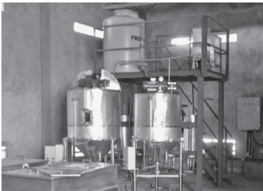
写真 7 ジャトロファ油の精製装置
