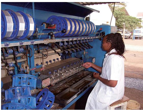
ICIPEでの縄糸：インド製の多条縄糸機
